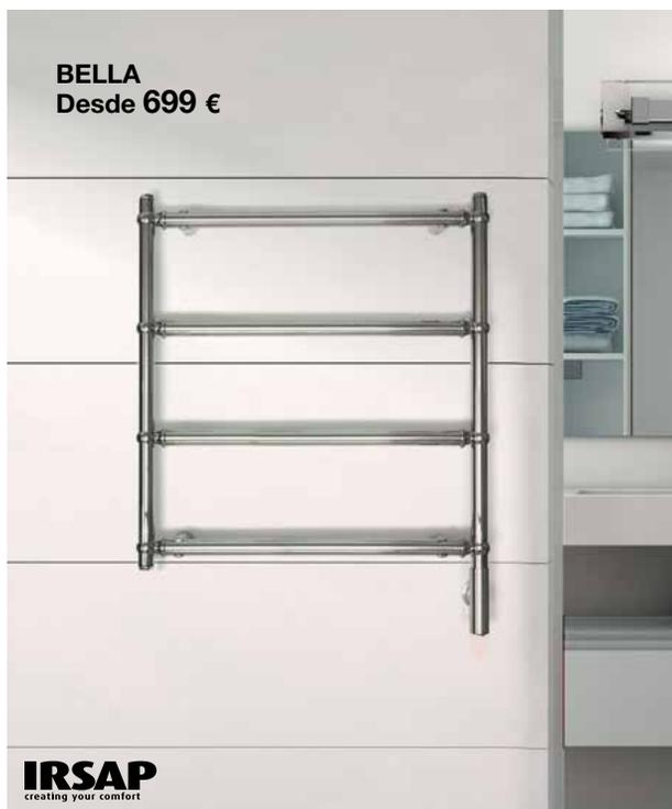
→ Radiador toallero en acero inoxidable y uniones en latón. Profundidad: 32 mm. Incluye soportes a pared del mismo color. Colectores verticales y horizontales de Ø25 mm. Relleno de líquido termoconvector. Incluye resistencia eléctrica instalada del mismo color con botón ON/OFF
