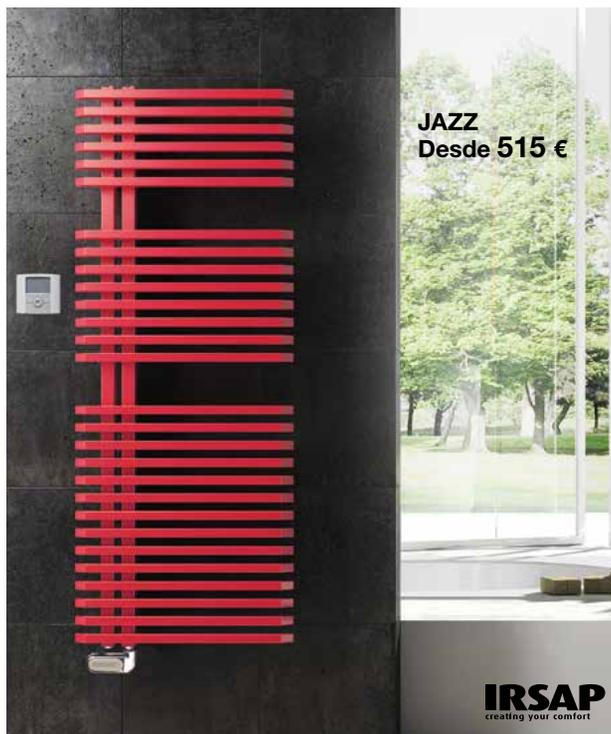
→ Radiador toallero en acero con resistencia instalada. Profundidad: 67 mm. Incluye soportes a pared del mismo color. Colectores verticales cuadrados 30 x 30 mm. Tubos horizontales 20 x 25 mm. Relleno de líquido termoconvector.
